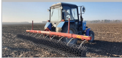
БОРОНА РОТАЦИОННО-КОЛЬЧАТАЯ БРК-5,6 (6,5 на опорных колесах, складная, укороченная)
