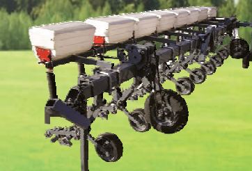
Культиватор навесной для высокостебельных культур КРН-2,8С; -4,2С; 5,6В; КРН-8,4С; КРН-11,2С
