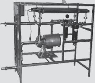
Комплекс КООМ предназначен для очистки цельного молока от механических примесей и биологических загрязнений (проявлений мастита, лейкоза, слизи, денатурированных белков) фильтрацией в дисковом фильтре тонкой очистки с последующим ультрафиолетовым обеззараживанием в установке бактерицидной обработки молока (УБО-М)
