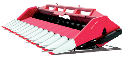
ЖАТКА ДЛЯ УБОРКИ КУКУРУЗЫ CORN STREAM 670/870/1270 6/8/12 рядков производительность 70 т/ч
