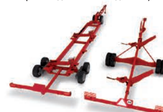
ТЕЛЕЖКИ ДЛЯ ТРАНСПОРТИРОВКИ ЖАТОК И СЕЯЛОК UNI CART 3000/4000 длина до 12 м грузоподъемность до 4000 кг
