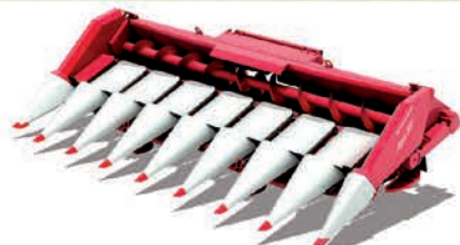
ЖАТКА ДЛЯ УБОРКИ КУКУРУЗЫ ARGUS 470/670/870/1270 4/6/8/12 рядков производительность до 40 т/ч
