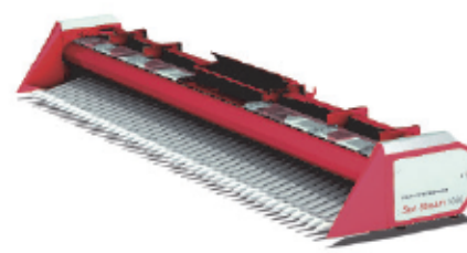
ЖАТКА ДЛЯ УБОРКИ ПОДСОЛНЕЧНИКА SUN STREAM 780/920/1050 ширина захвата до 10,5 м производительность до 8,3 т/ч
