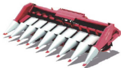
ЖАТКА ДЛЯ УБОРКИ КУКУРУЗЫ ARGUS 470/670/870/1270 4/6/8/12 рядков производительность до 40 т/ч
