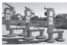
Продать энергосберегающие, широкозахватные, скоростные плуги ПСКУ-2, 3, 4, 5, 6, 7, 8, 9, 10 корпусов производства Энгельса. Рама из двутавра, ширина захвата одного корпуса 60 см, экономия топлива до 9 кг на каждом гектаре. Доставка. Тел.: 8-928-187-40-05.
