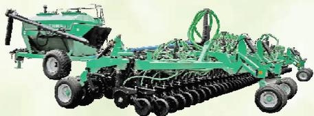
Широкозахватный посевной комплекс «Томь» предназначен для посева по нулевой технологии с одновременным внесением семян и удобрений
