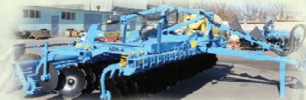
Агрегат дисковый складной «АДС-6» предназначен для обработки почвы на глубину от 2 до 12 см.
