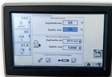
Однако водитель может и сам настраивать предельную нагрузку, а также снижение числа оборотов в диапазоне частичной нагрузки.
