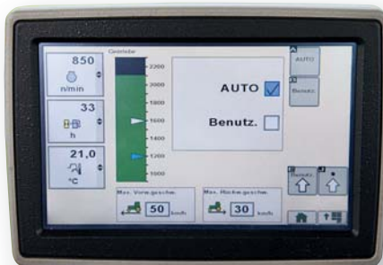
Если в терминале CommandCenter активирована автоматика, то все регулировки коробки передач, такие как момент переключения, осуществляются автоматически.
