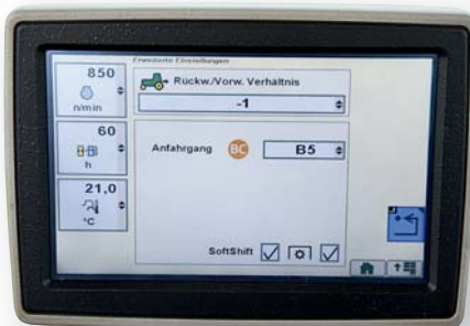
Кроме того, существует возможность регулирования соотношения „вперед“/„назад“, а также программирования скорости при трогании с места в диапазоне передач „В/С“.
