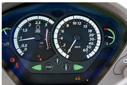
... а диоды показывают значение на тахометре. Кроме того, слева можно узнать, какой диапазон передач и какая ступень в данный момент выбраны. 50 км/ч – и всего 1 600 оборотов!
