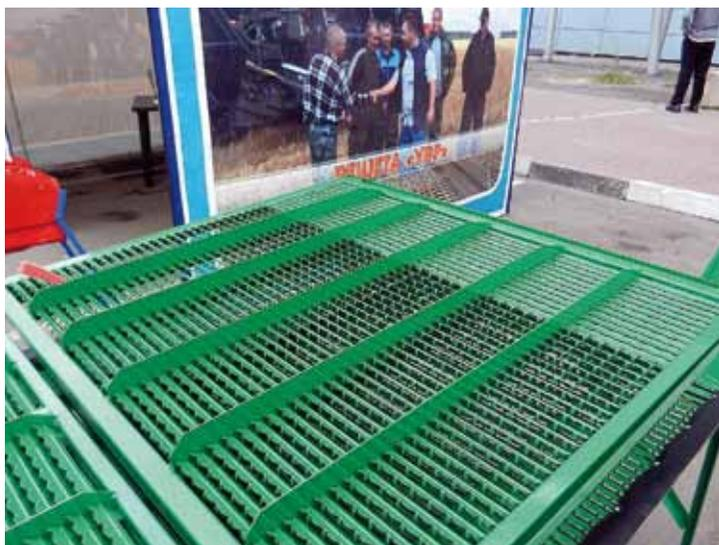
Компания «Евросибагро» наладила выпуск универсальных высокопроизводительных решёт, они подходят на любые модели комбайнов и для уборки любых культур. Эффект от установки универсальных высокопроизводительных решёт многоплановый: пропускная способность и производительность комбайна возрастает до 15%, потери зерна снижаются на 30 и даже 50%. Кроме того, на выходе аграрии получают меньше дроблёного зерна.
