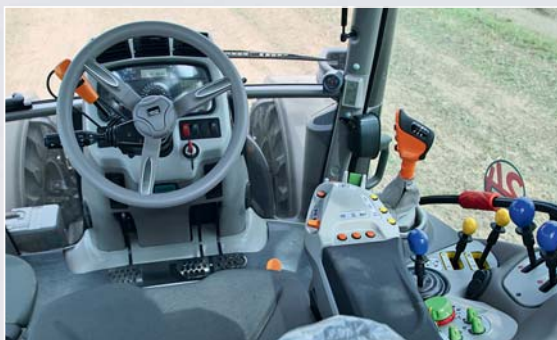
Переключение по схеме „двойная Н“ (с новым рычагом) расположено по диагонали к направлению движения. Кроме функции Speedmatching, для смены переключаемых под нагрузкой ступеней теперь имеется функция SenseShift.
