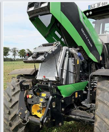
Пакет охлаждения благодаря газовым амортизаторам очень легко поднимается.
