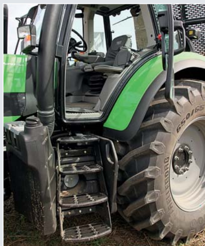
Новая лестница имеет теперь вместо трех – четыре ступени. Обшивка внутри кабины – высококачественная, а сиденье пассажира – мягкое.
