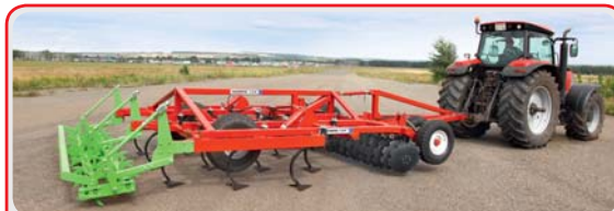
Дисковый глубокорыхлитель « TERRAMASTER »
