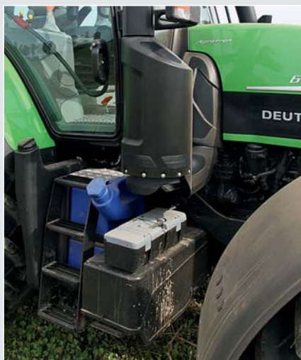
35-литровый бак для AdBlue может наполняться только с правой стороны, 300-литровый дизельный бак – с обеих сторон. Катализатор SCR располагается внизу в утолщенной выхлопной трубе.
