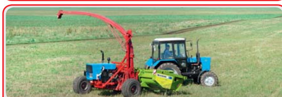
Комбайн кормоуборочный прицепной « МАК - 300 Автоном »
