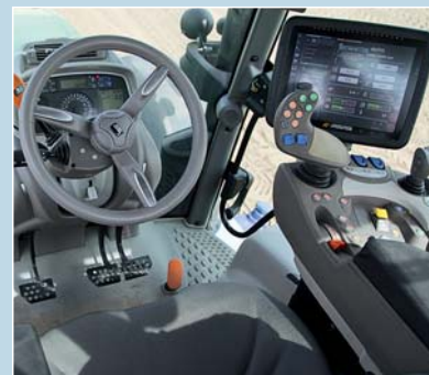
Подлокотник управления и multifunctionальный рычаг для 7-й серии были полностью изменены. Большой экран, к сожалению, отсвечивает.
