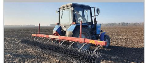
БОРОНА РОТАЦИОННО-КОЛЬЧАТАЯ БРК-5,6 (6,5 на опорных колесах, складная, укороченная)
