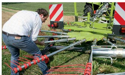
Перед началом работы необходимо монтировать зубья. Несмотря на однозначное обозначение, граблину все же можно вставить неправильно.
