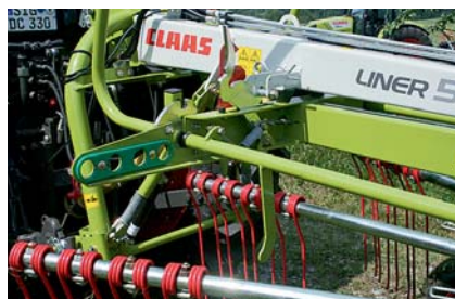
Пружинный зажим фиксирует карданную навеску во время движения, если фартук поднят вверх.
