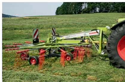
Благодаря 6-колесному шасси и карданной навеске хорошее копирование ротором рельефа почвы обеспечено.
