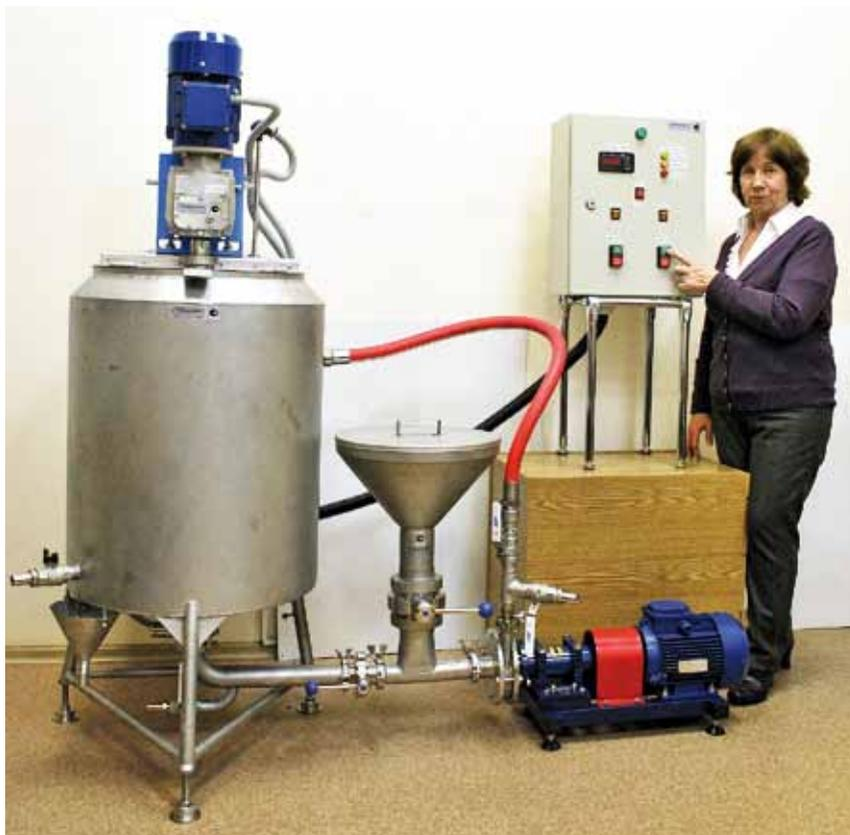
**Рис. 1.** Установки приготовления эмульсий и суспензий (УПЭС) выпускаются предприятием ИТП ПРОМБИОФИТ как для оснащения производственных цехов (объём рабочей ёмкости от 50 до 600 литров), так и для лабораторной обработки технологии производства (объём 10-20 литров)
