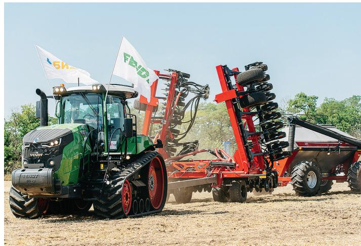
тое поколение гусеничного модуля, модернизированную подвеску с двумя точками качания опорных катков, – сообщил Иван Моржаков, сотрудник компании AGCO-RM. – Это значительно повышает их эффективность: лучше сцепление с почвой, больше передаваемая мощность, меньше уплотнение. Тракторы могут работать в более тяжёлых условиях без риска пробуксовки. При этом расход топлива минимальный. Например, Fendt 943 MT с 12-метровой дисковой бороной Heliodor расходует всего 4 л/га.
