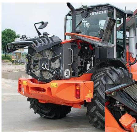
Благодаря складываемой обшивке и откидному радиатору точки техобслуживания хорошо доступны. Горловина топливного бака расположена в защищённом месте за противовесом под обшивкой.
