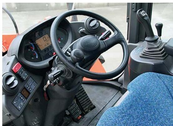
Элементы управления расположены обдуманно. Мультифункциональный джойстик способствует более чувствительному управлению рабочей гидравликой.
