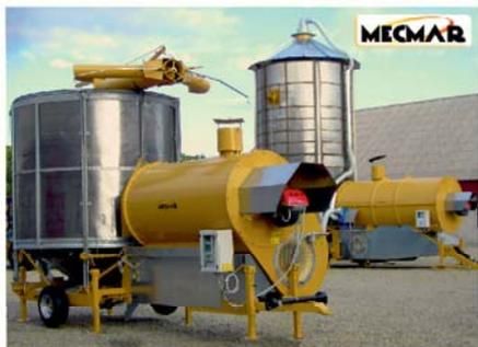
Компания спроектировала, разработала и ввела в эксплуатацию самый широкий ассортимент мобильных зерносушилок от 9 м<sup>3</sup> до 102 м<sup>3</sup>.
