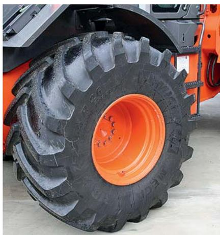
Большие рабочие тракторные шины размером 750/65 R 26 относятся к сельскохозяйственному оснащению машины.
