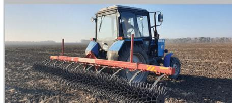
БОРОНА РОТАЦИОННО-КОЛЬЧАТАЯ БРК-5,6 (6,5 на опорных колесах, складная, укороченная)
