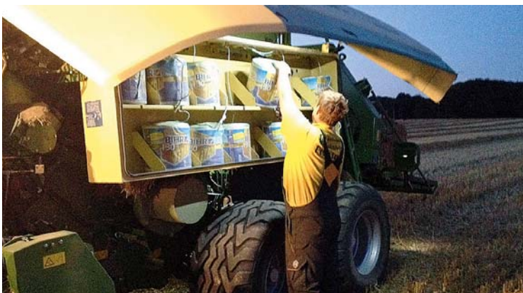
Ящики для шпагата справа и слева вмещают до 32 катушек и тоже имеют светодиодное освещение. По желанию можно получить место ещё для дополнительных 2х6 катушек.
