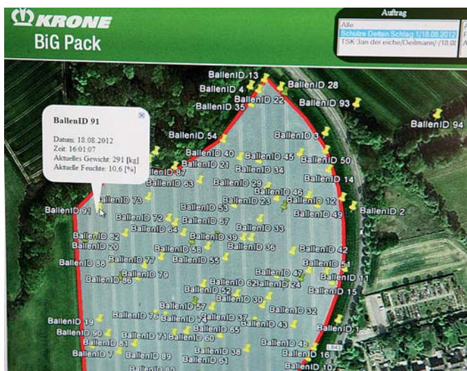
Вместе iCAN устанавливается программное обеспечение, которое сохраняет данные и позицию каждого отдельного тюка и передаёт информацию на офисный компьютер.
