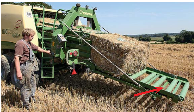
Выталкиватель тюков и спускной лоток имеют удобное управление кнопками, расположенными сзади на прессовальном канале. Четыре тензодатчика (см. по стрелке) определяют вес тюка во время работы с отклонением менее 2%.
