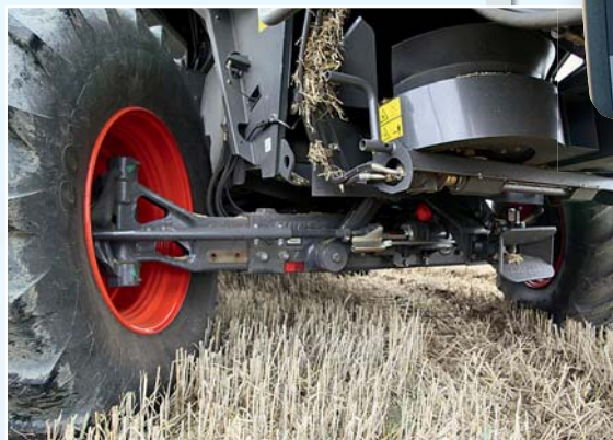
Четырехшарнирный задний мост имеет запатентованную трапецевидную навеску. Благодаря раскачиванию в стороны, здесь образуется достаточно места для колес высотой 1,65 м.
