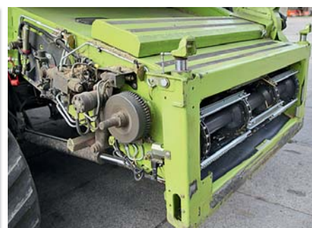
Тормоз жатки больше не производит торможение вариатора. Это уменьшает износ.
