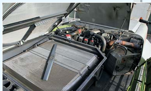
Огромные охладители для воды, воздуха и масла располагаются горизонтально рядом друг с другом на капоте соломотрясы, и воздух всасывается сверху через большую поворотную решетку длиной 1,60 м. Двигатель V8 имеет катализатор SCR (справа на снимке) и развивает в новой топ-модели 780 максимально 440 кВт/598 л.с. мощности.
