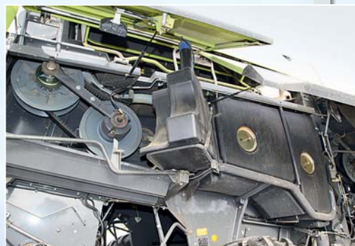
Бак для AdBlue (80 л) поворачивается, открывая доступ к приводу ротора. Основной и дополнительный бак для дизеля (800 и 350 л) имеют теперь только одну горловину.
