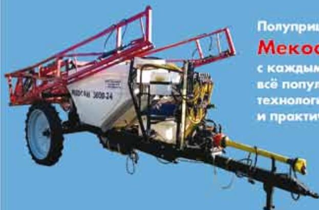
Полуприцепной штанговый опрыскиватель
