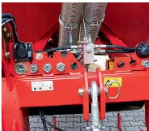
Благодаря стандартному трехточечному устройству навески, агрегат FlexCart является универсальным носителем сельхозорудий. Его полноценность, обзорность и расположение соединений почти не оставляет пожеланий.
