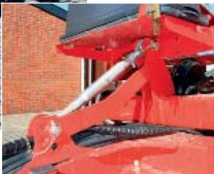
личие практических держателей. Шланги имеют обозначения в виде цветных пластиковых клипс, наклейка обеспечивает ориентировку при подключении. Здесь в зависимости от трактора проблематичным может быть только соединение короткого карданного вала, который не имеет парковочной позиции.
