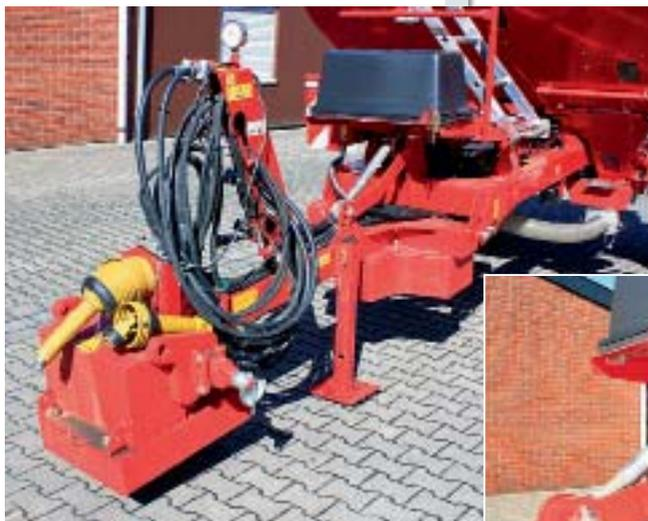
Для хорошей маневренности FlexCart навешивается на нижние тяги трактора. Противовесы препятствуют возникновению негативной нагрузки (слева). Шпindel служит для приведения в горизонтальное положение, имеется дополнительная тяга для жесткого соединения (внизу).
