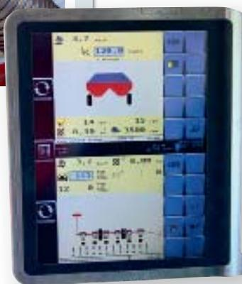
Благодаря разделенному дисплею терминала Iso-MatchTellus можно удобно наблюдать за работой двух орудий.
