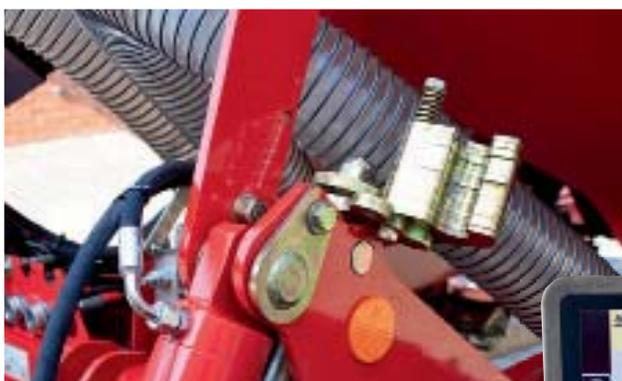
Сеялка выравнивается с помощью поворачиваемых разделителей (справа). Слева на цилиндре ходового механизма находится датчик для включения и выключения дозирующего устройства на разворотной полосе.
