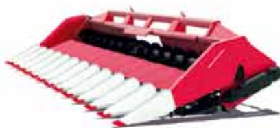
ЖАТКА ДЛЯ УБОРКИ КУКУРУЗЫ CORN STREAM 670/870/1270 6/8/12 рядков производительность 70 т/ч
