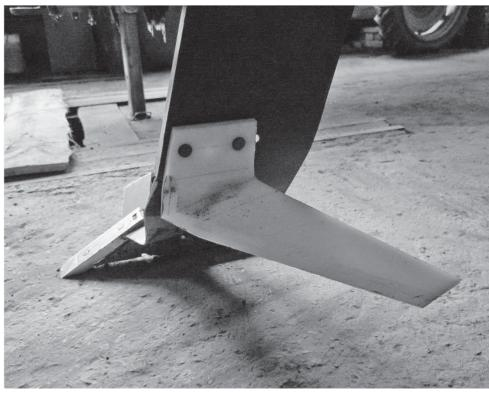
С пластиком снижается коэффициент трения, расход горючего, лучше качество обработки почвы
