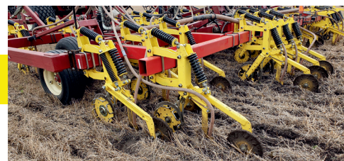
Анкерный сошник А-03ПКР на параллелограмной подвеске
