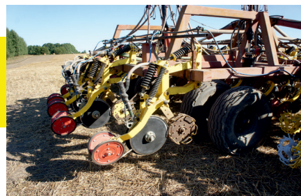
Прикатывающее колесо 300х25 адресное, копирующее, с поворотным механизмом
