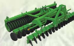
Дисковая борона "КДК" (аналог "CATROS") с рабочей шириной захвата от 4 до 9 метров Борона предназначена для обработки почвы на глубину до 12 см с твердостью до 4,5 мПа при влажности до 30% во все периоды полевых работ.
