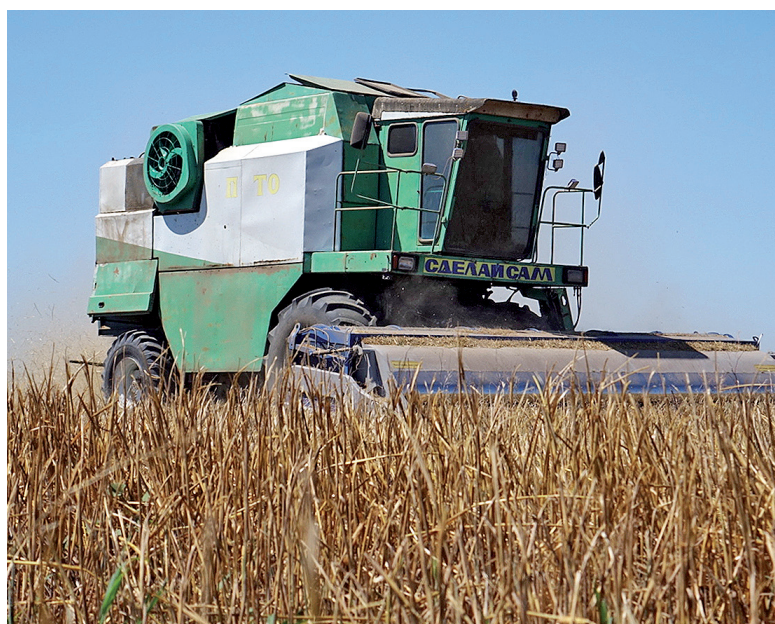
Переделанный комбайн с новой очёсывающей жаткой убирает урожай быстро
