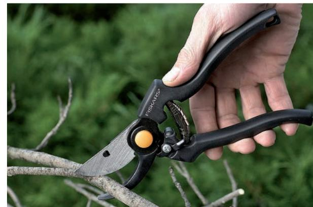
Для этого подходят: специальная смазка для садового инструмента Felco 990, графитовая смазка, литол или машинное масло. Если на опорном лезвии есть желобок для смазки, его заполняют смазочным составом. Если углубления нет, нанесите на лезвия в местах их соприкосновения 3-4 точки, несколько раз закройте и раскройте секатор, чтобы состав распределился равномерно. Перед длительным хранением не помешает также обработать пружину, винт или клёпку.
